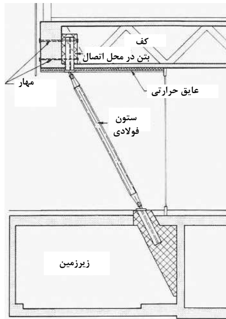
نمایش مقطع خرپای مورب جدید در طبقه همکف (Schefer, Zwicky, Santchi, 1995)
